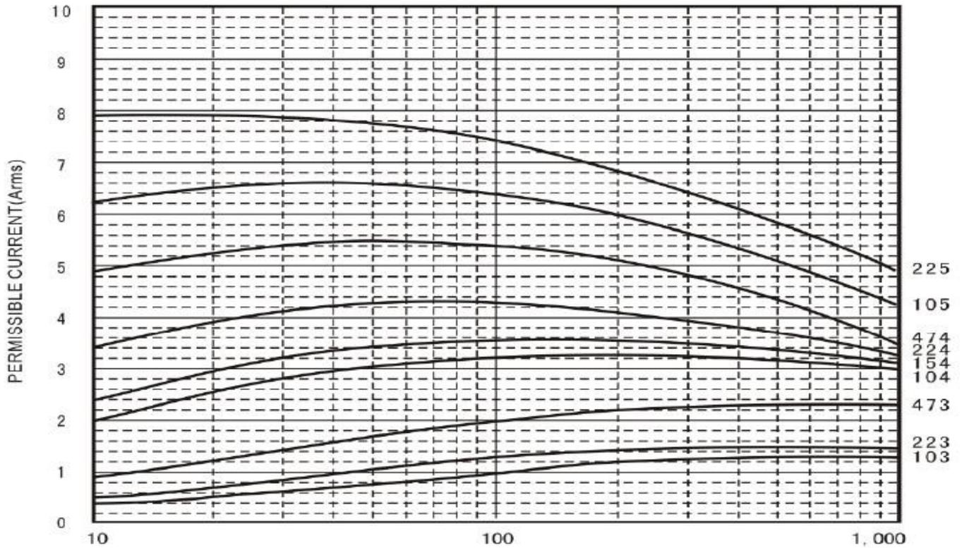
允许电流 ( Arms ) 对频率特性曲线图 ( 正弦波,  $\Delta T \leq 12^\circ\text{C}$ )
